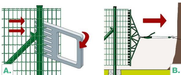
**6** Je-li délka oplocení větší, než návin jedné role (zpravidla 25 bm), **sítě spojte na sloupcích, nebo mimo sloupky** – přeložte krajní řady ok přes sebe a konce křížně spojte pomocí svorek. Na posledním sloupku síť dostatečně napněte a upevněte ji svorkami CLIP k montážnímu nosu. Přesahující oka zastříhnete.
